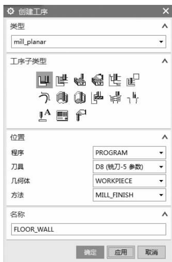
图 1-43 FLOOR_WALL 工序设置
