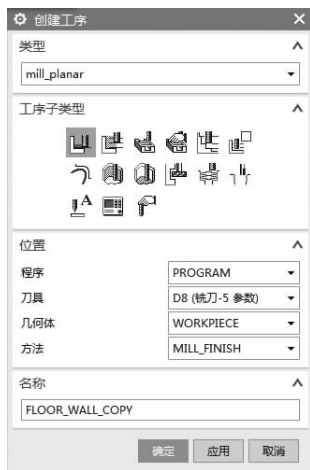
图 1-67 FLOOR_WALL_COPY 工序设置
