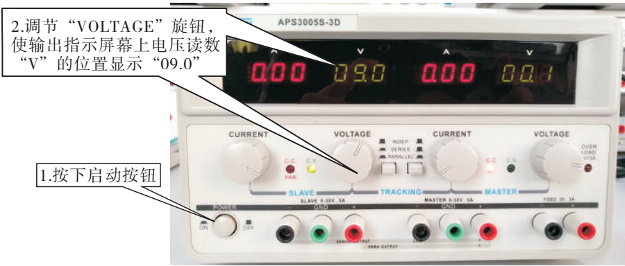
图 2-13 调节直流稳压电源的输出
