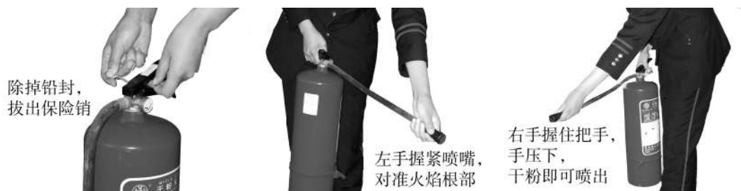
图 1-38 常用灭火器的使用方法
