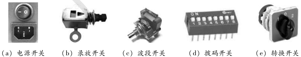
图 2-35 按照用途分类的开关
