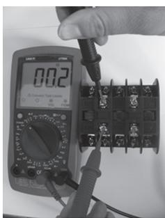
图 1-22 常闭触点检测
