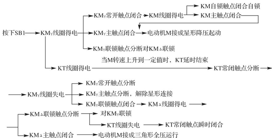
图 4-12 电动机 Y-Δ 降压起动电路的工作过程
