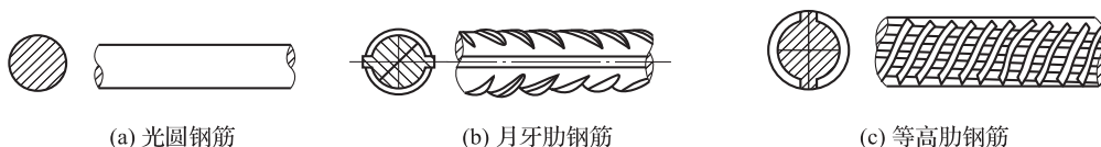
图 1-1 热轧钢筋的表面形式
