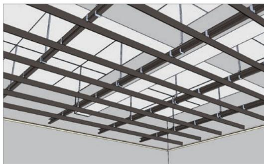
安装次龙骨：根据铝扣板的规格尺寸，安装与板配套的次龙骨，次龙骨通过吊挂件吊挂在主龙骨上。
