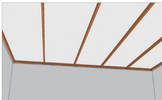
铺设固定龙骨：多采用木方做龙骨，间距根据面板规格确定，一般采用胀管螺栓或射钉固定，也可以采用冲击钻打孔，埋设锥形木楔的方法固定。
