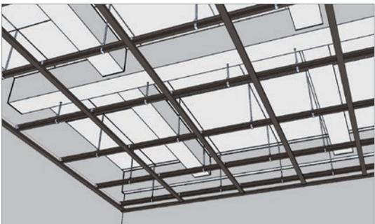
安装次龙骨：次龙骨应紧贴主龙骨安装。固定板材的次龙骨间距不得大于 600 mm，在潮湿的地区和场所，间距宜为 300~400 mm，用沉头自攻钉安装饰面板时，接缝处的次龙骨宽度不得小于 40 mm。
