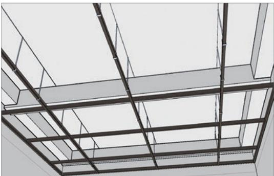
主龙骨采取对接接长，相邻龙骨的对接接头要相互错开。轻钢龙骨挂好后应基本调平。
