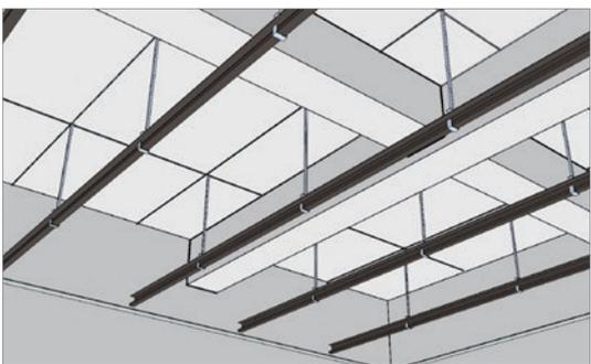
安装边龙骨：按天花净高要求在墙四周用水泥钉固定烤漆龙骨，水泥钉间距不大于 300 mm。
