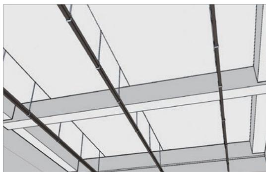
轻钢龙骨安装：轻钢龙骨应吊挂在吊杆上，一般采用 38 轻钢龙骨，间距 900 ~ 1 000 mm。龙骨应平行房间长向安装，同时应起拱，轻钢龙骨的悬臂段不应大于 300 mm，否则应增加吊杆。
