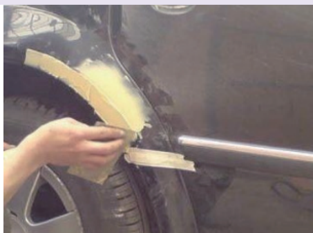
图 1-7 车身凹陷处原子灰的刮涂
