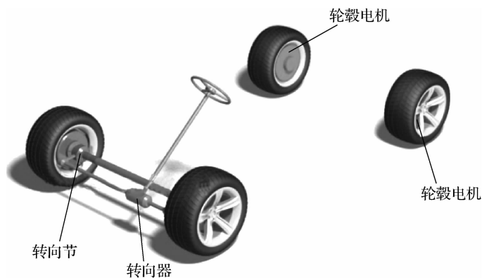
图 2-6 轮毂电机驱动布置形式
