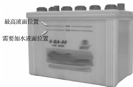
图 1-39 蓄电池电解液液面的检查
